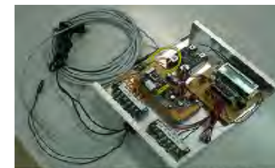
▲ロードヒーティング用温度 コントローラ(電子情報技術科)
