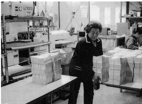
低位昇降テーブルを設置したことにより作業負担が軽減された。
