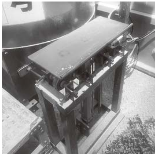
自動化がむずかしい工程に導入した自社製作の簡易的な昇降機
