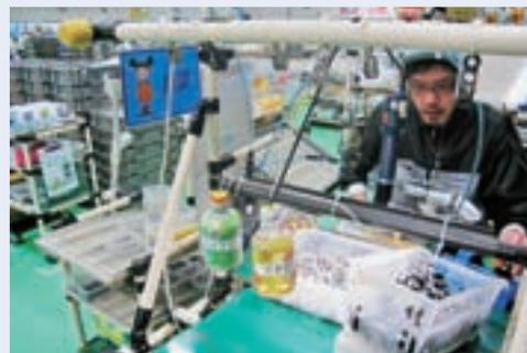
吊り下げられた工具(工具の重さに応じて重りの重量を変えることができる)
