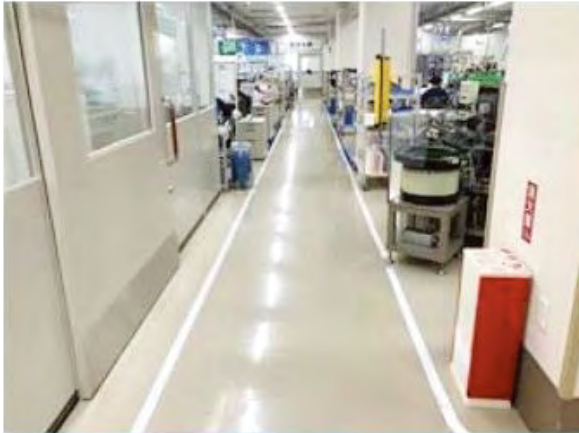
作業場周辺の通路幅は 120cm 以上、作業場内は 90cm 以上を確保
