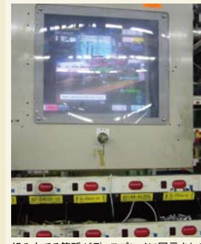
組み立てる箇所がディスプレイに図示されるとともに、必要な部品のランプが点灯する
