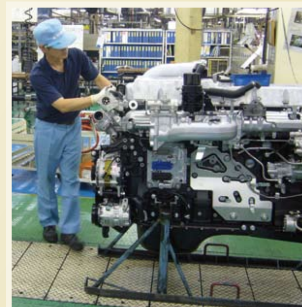
組み立てる箇所がディスプレイに図示されるとともに、必要な部品のランプが点灯する
