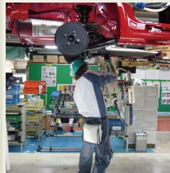
足回り部品の組み付け作業
