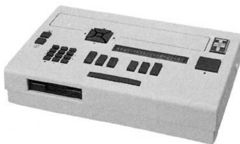
寸法：横390×奥行260×高さ80mm 点字ディスプレイ型式
