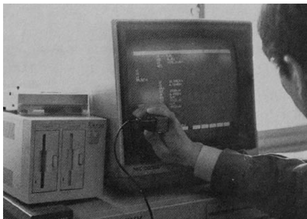
ディスプレイの中の、読み取りたい位置に、小型カメラをあてる
