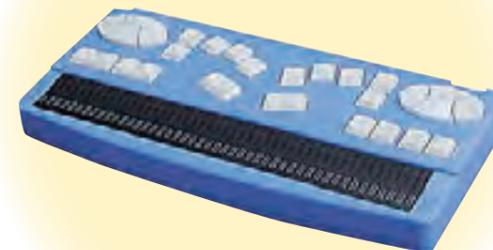
点字ディスプレイとは、点字対応ソフトウェア（スクリーンリーダー）などが出力した情報を点字で表現するための機器です。主に点字を使用する全盲のユーザーに利用されており、画面の情報、テキスト・データ、点字データなどをリアルタイムに点字として表示する装置です。
