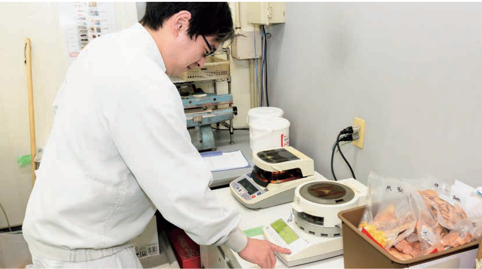
水分量の測定。設定の異なる測定装置2台を同時進行で使用する
