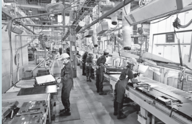
テレビの解体ライン。家電リサイクルは人の手で行われている
