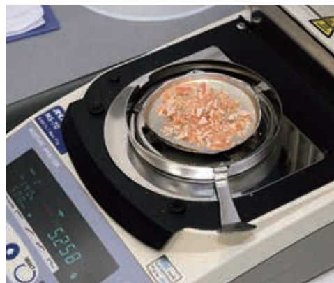
細かく切り刻んだペットフードを測定装置にセットする
