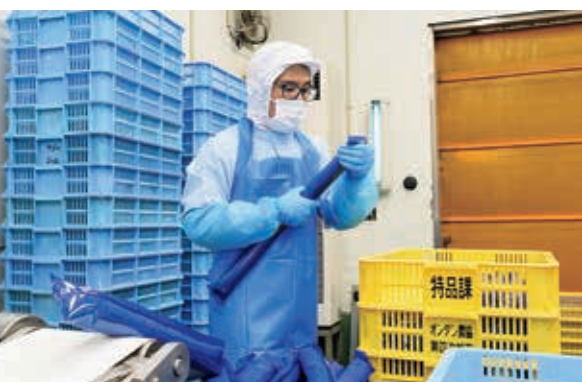
充填機から送り出されたケーシングの端部をひねって絞り、形を整える寺岡さん
