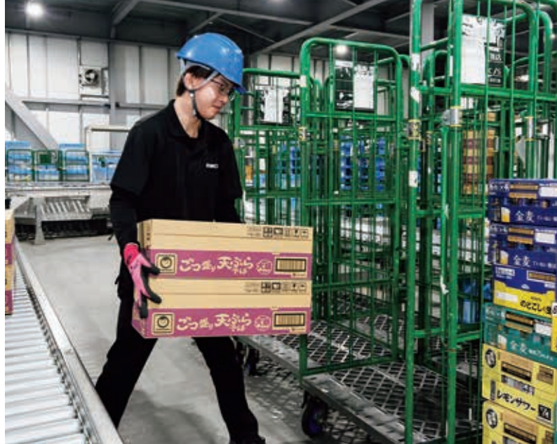
①コンベアでエリアごとに仕分けられた商品を店舗ごとのカゴ台車に積み込む「ケースシュート」は、宮誠樹さんが得意とする作業の一つだ
