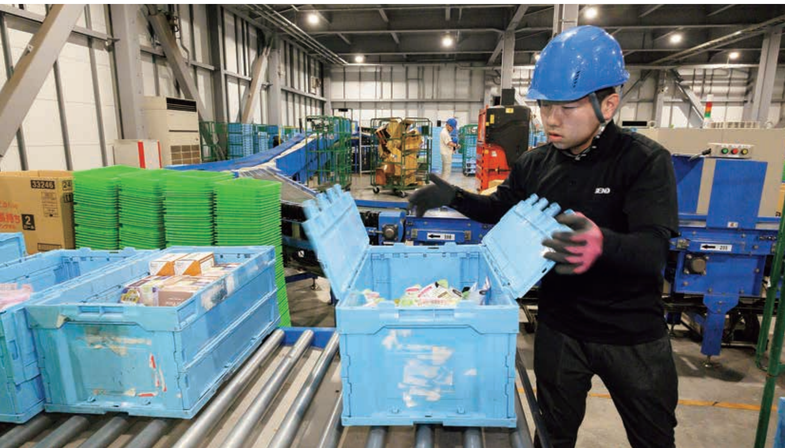
商品の入ったコンテナを検品ラインに投入する鈴木由斗さん。検品の担当者が作業を行いやすいようにコンテナの蓋を開けラインに投入する
