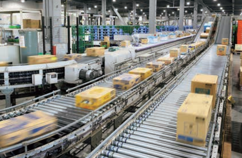
PDセンターの一角。コンベア上をさまざまな商品が行き交い、商品外装に貼りつけられたラベルをもとに自動で配送エリアごとに仕分けられる
