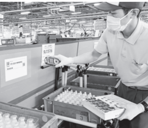
ピッキング工程では、二次元コードリーダーを活用しミスを防いでいる
