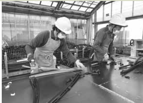
電線リサイクル業務、被覆剥ぎ作業の様子
