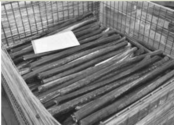
電線は1m程度にカットされ搬入される
