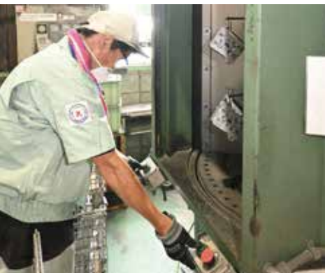
装置は、事故防止のため左右のスイッチを同時に押さないと動かない
