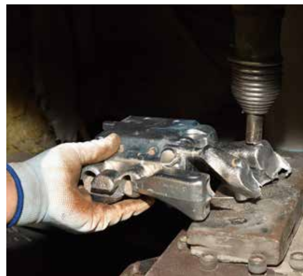
ブラスト装置に部品をセットする。 正しい位置に取りつけることがポイント
