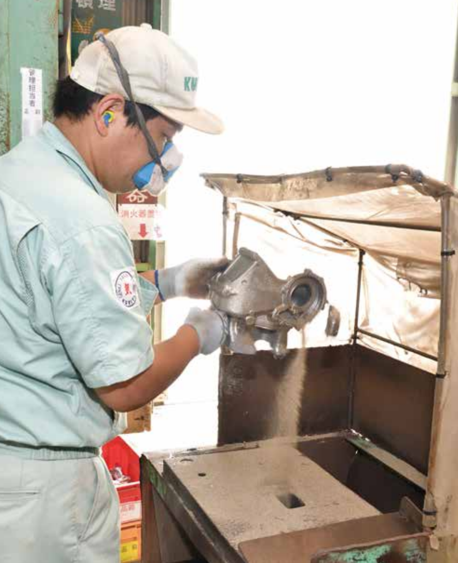
ブラスト装置から取り出した部品を、作業台に打ちつけ内部に残った砂を取り除く
