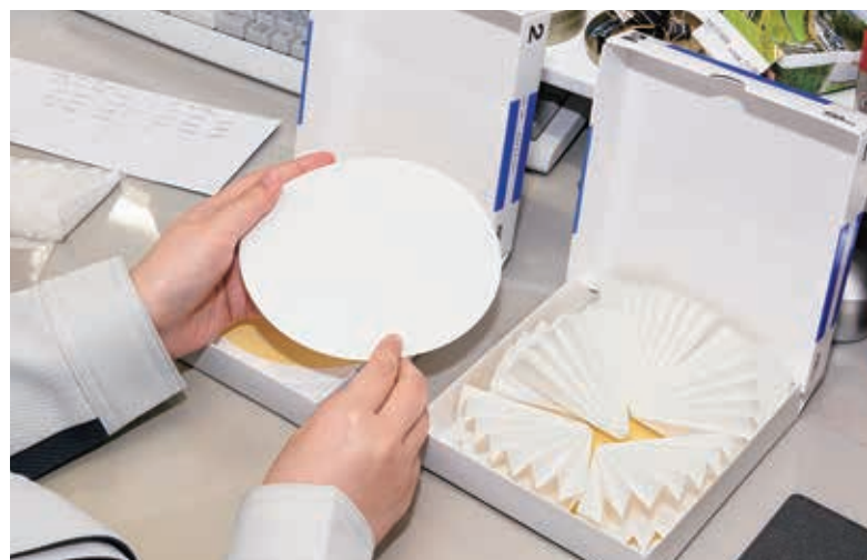
門田さんは「ろ紙折り」も担当。写真左側のろ紙を折りこみ、写真右側のようにろ紙に“ひだ”をつける。集中力が求められる業務だ
