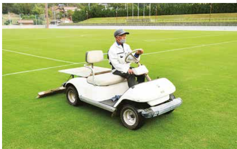
カートに取りつけたブラシで、グラウンドの芝についた朝露を落とす。 芝刈り前の大切な工程だ
