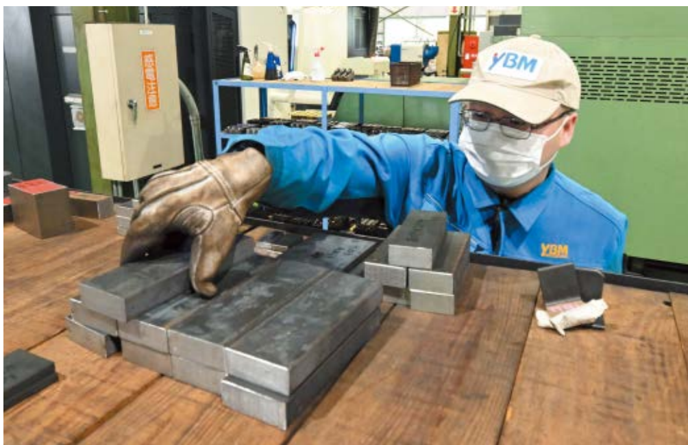
切り出しとバリ取りを終えた部材を後工程の作業エリアに届ける
