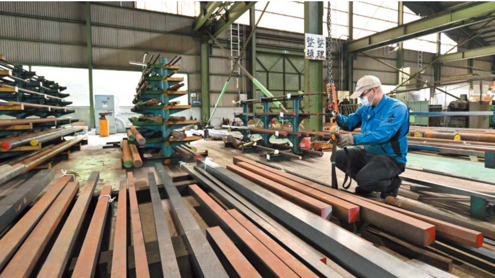
さまざまな種類のある鋼材のなかから指定の物を選び、クレーンで吊り上げる
