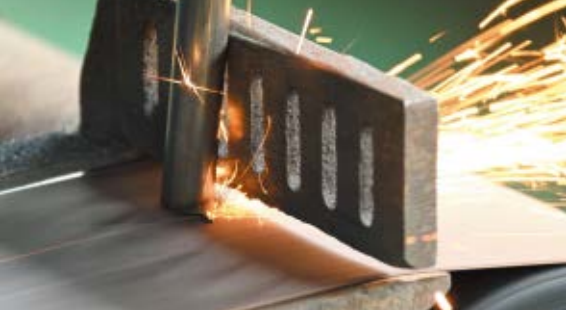
ベルトサンダーでのバリ取り作業。 切断時にできた意図しない突起（バリ）を除去する
