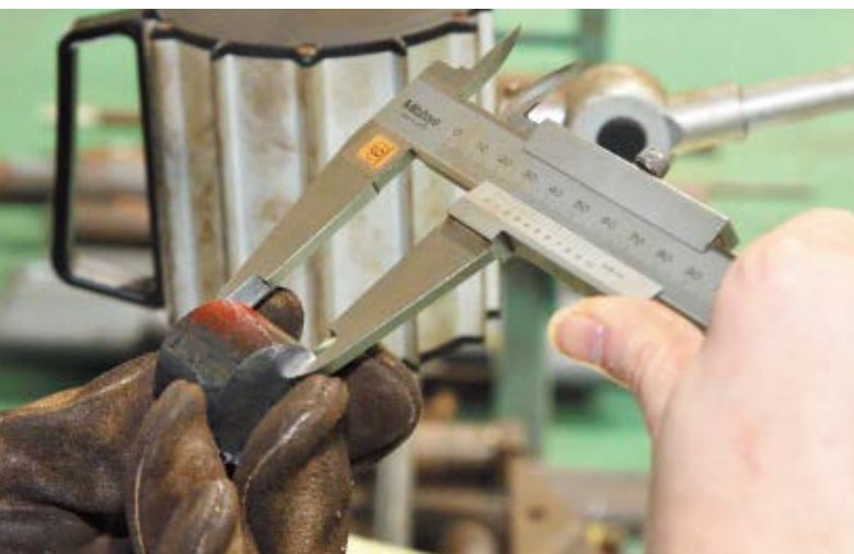
加工後、ノギスを使い長さを確認する。 ここでの精度が製品の精度にもつながる、重要な作業
