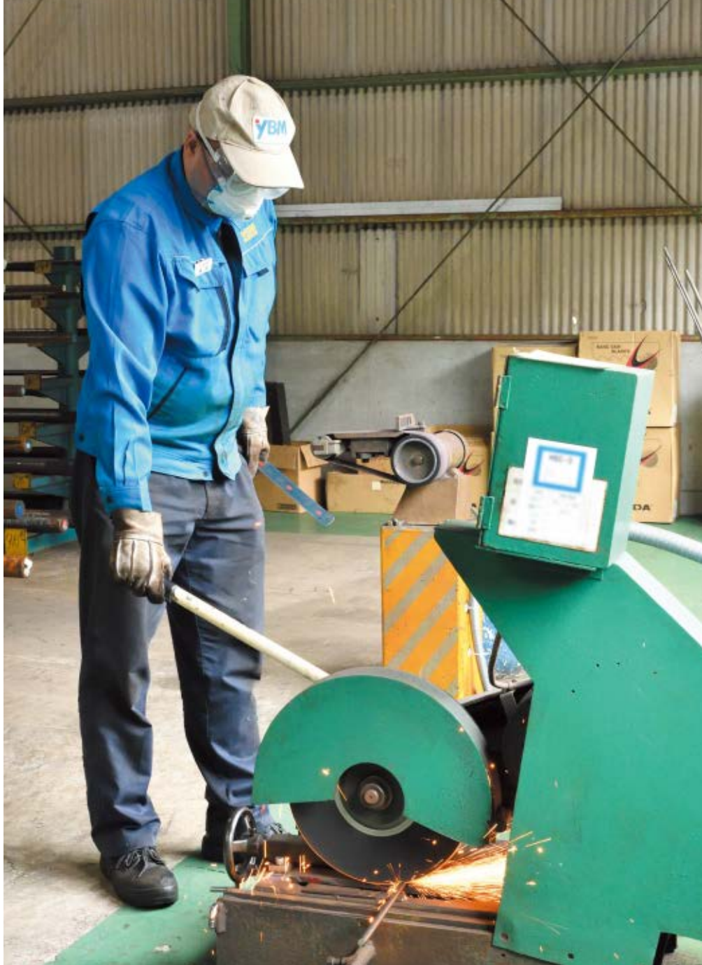
「高速切断機」で棒材を切断する。 防護ゴーグル、防塵マスクを装着して作業にあたる
