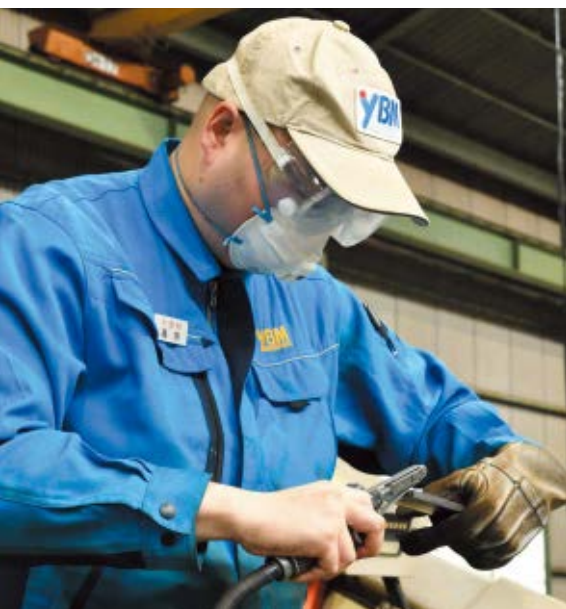
平材のバリ取り作業。 手持ちのベルトサンダーで作業を行う
