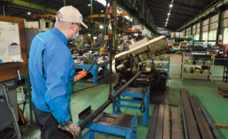
クレーンをリモコンで操作し鋼材を移動、 「のこ盤」にセットする
