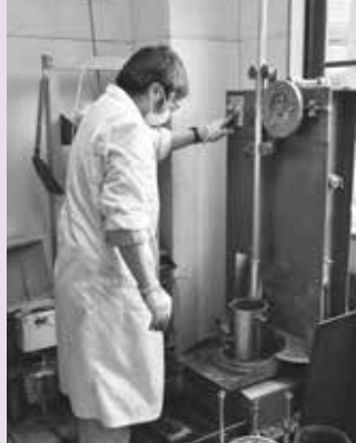
土質試験を担当するEさん。検査用に供試体を作製している様子
