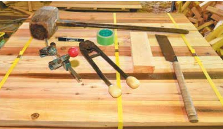
梱包用木材の固縛では、PPバンドの引締機のこぎりや鋸などの道具を使用する
