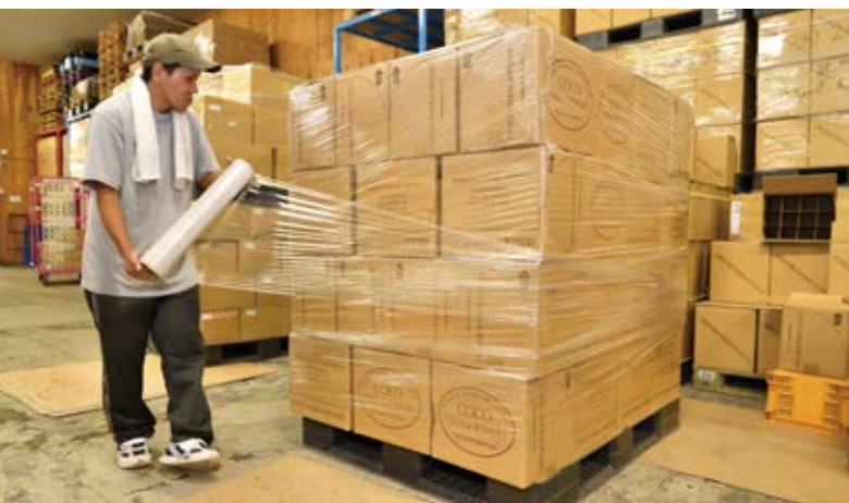
出荷作業の一コマ。荷崩れを防ぐためにフィルムを巻きつける
