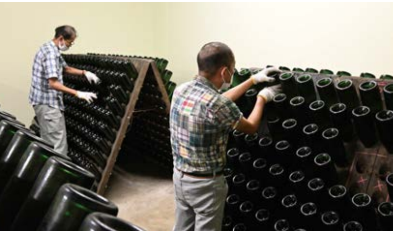
発酵によって生じた おり 澱をボトルの口に集める「ルミアージュ」。 決められた角度にボトルを回転させる繊細な作業であり、 正確に同じ作業をくり返すことが得意な園生が担当している
