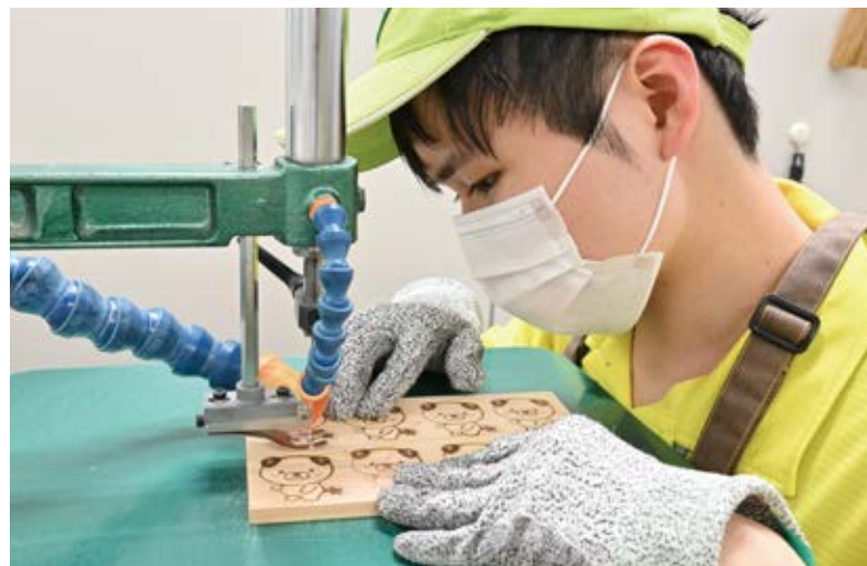
②切り出し。糸のこを使い、焼印に沿って一定の間隔で切り出す。ケガ防止のため、専用の手袋を使用する
