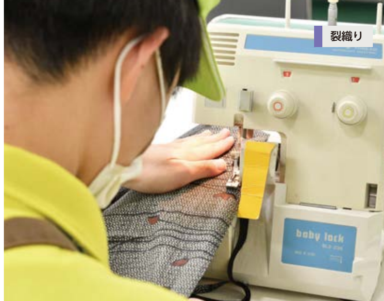
①着物や浴衣などを裂いて緯糸とする。 ロックミシンのメス（カッター）を使い、作業している
