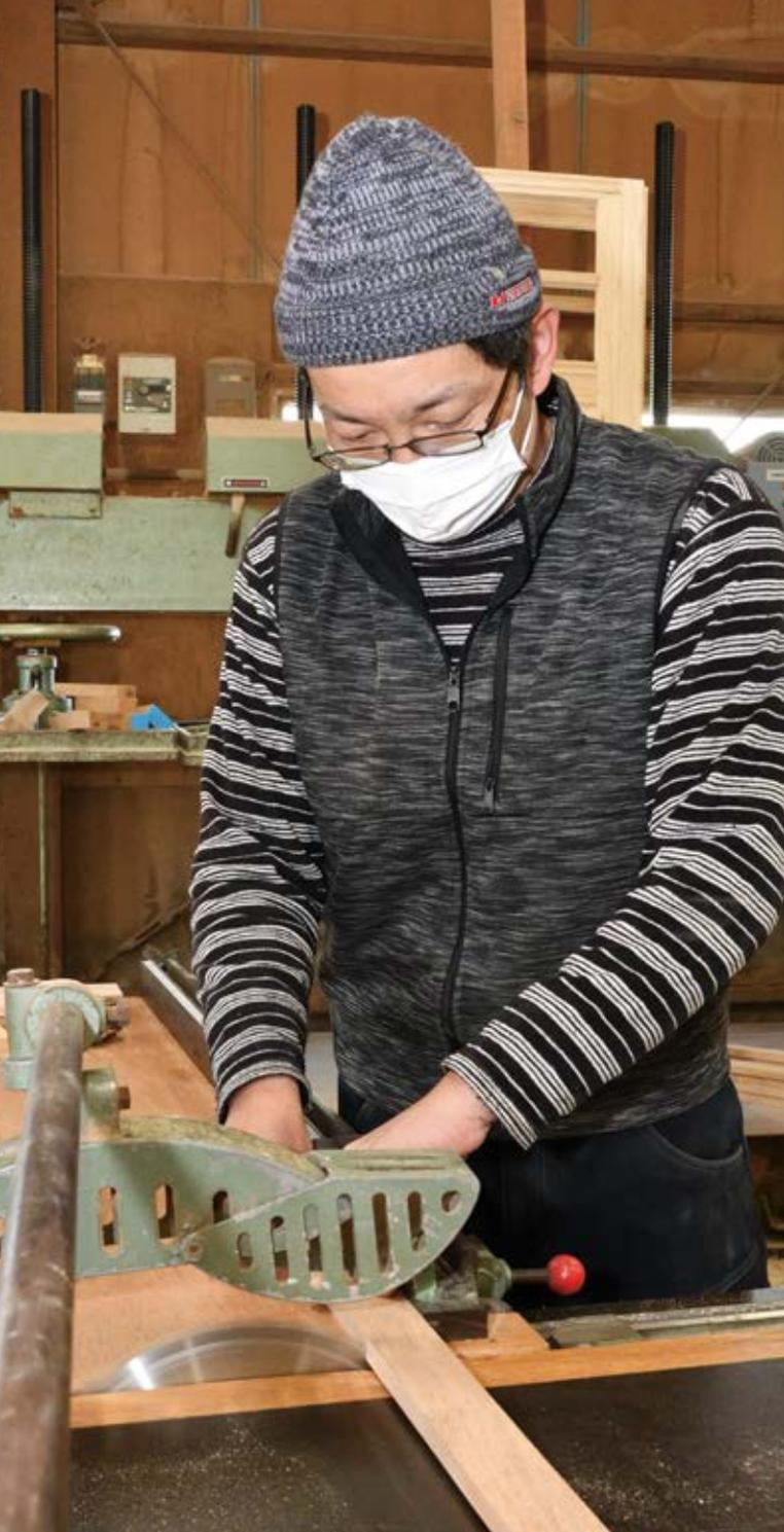
昇降盤という電動工具で板材を切断する。慎重に作業を進める
