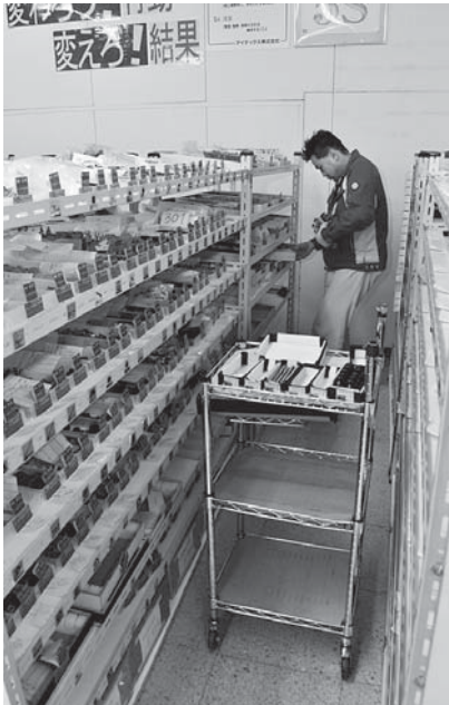
部品供給を担当する桑原昌和さん。部品棚から必要な部品を取り出し、各作業部署に供給する
