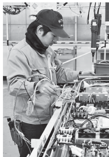
エレベーターの制御盤の配線作業をする清水隆之さん
