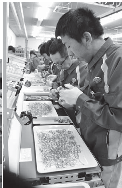
LED蛍光灯の組立ライン。ベルトコンベアの上の各自の名前が書いてあるところに部品を載せる
