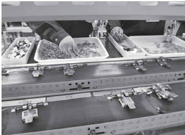
LED蛍光灯の組立ライン。ベルトコンベアの上の各自の名前が書いてあるところに部品を載せる
