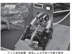
グリス塗布装置:刷毛による手塗り作業を解消 (セットするだけで簡単にグリス塗りが可能)
