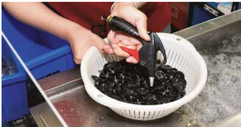
洗浄した部品にエアガンで空気を吹きかけ、水滴を落とす。 その後カゴに移し替え、乾燥させる
