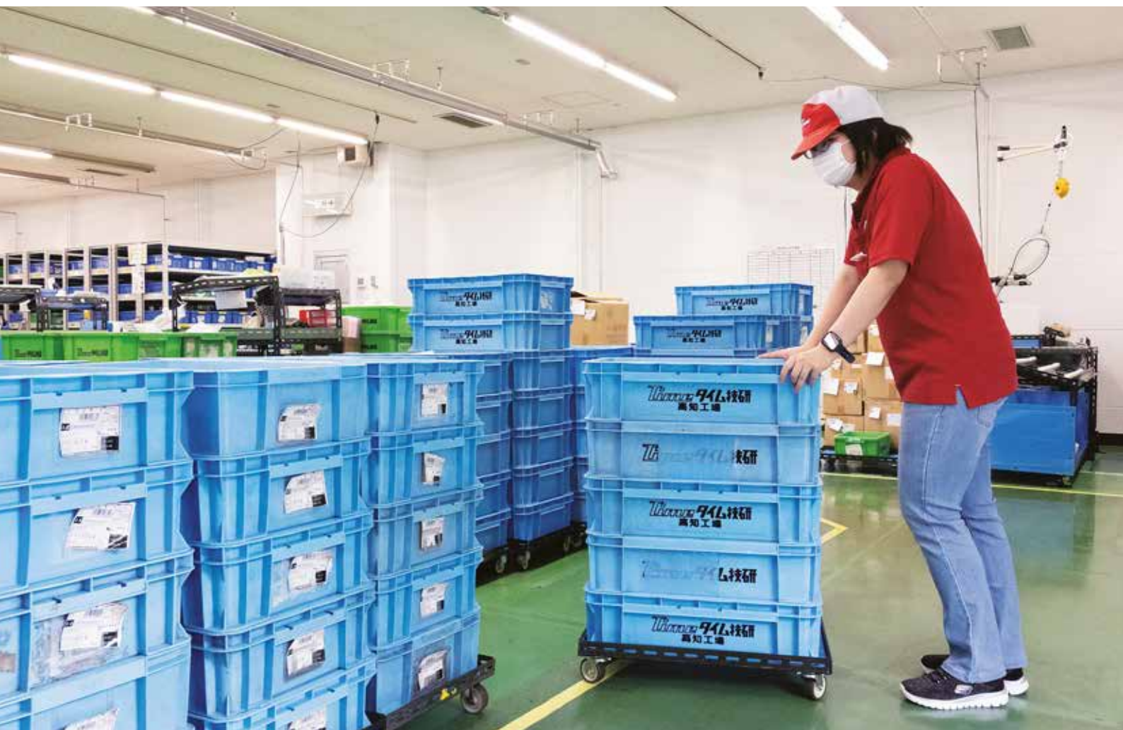
部品の入ったコンテナを保管場所に運ぶ。コンテナを積み上げる段数も定められており、安全面も配慮されている
