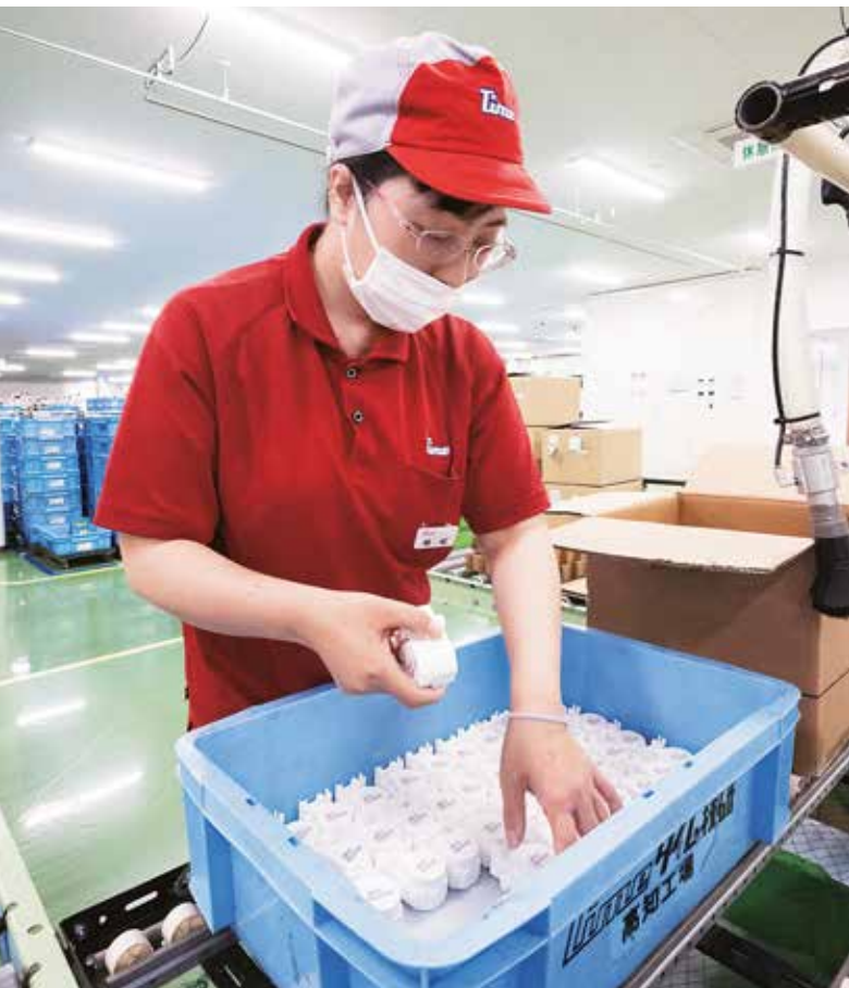
嶋崎さんは「箱入れ」も担当。バキュームをかけた部品をコンテナに移し替える。 製造エリア内にほこりなどを持ち込まないために欠かせない工程だ
