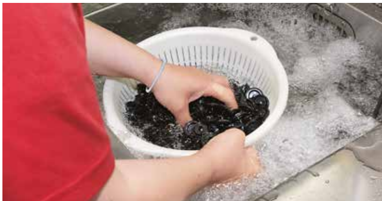
シンクに水を貯め、空気を送り込むブロー装置を作動させる。 部品をざるに入れ水洗いし、ゴミや不良品などを取り除く
