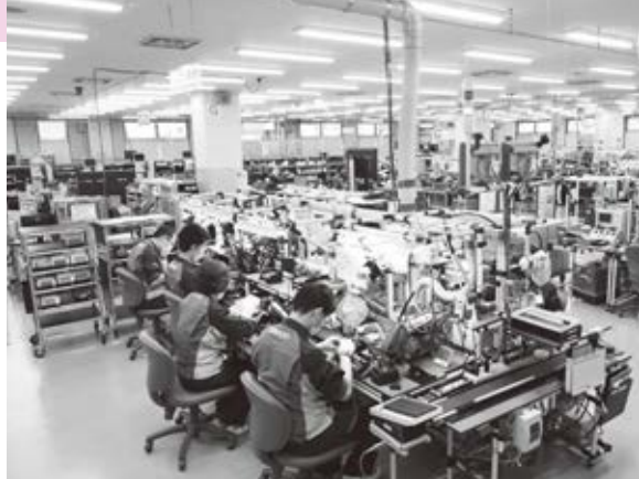
オムロン京都太陽 製造課のフロアでは、 タイマーなどの各種電子部品が製造されている
