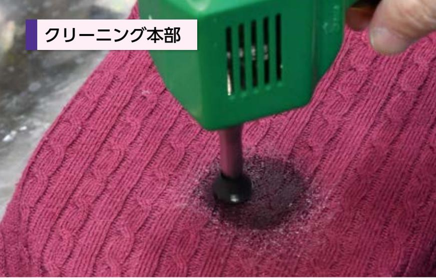
超音波洗浄機による染み抜き工程
