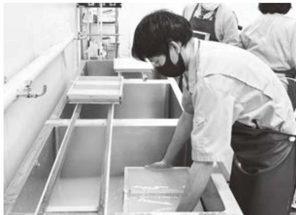
網枠を使ってすいていく。仕上がりを左右する大事な工程だ
