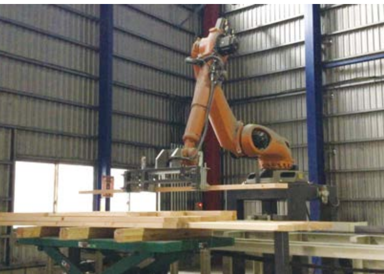
指示に従い、ロボットアームが木材を積み上げる (写真提供：ボラスシェアード株式会社)
