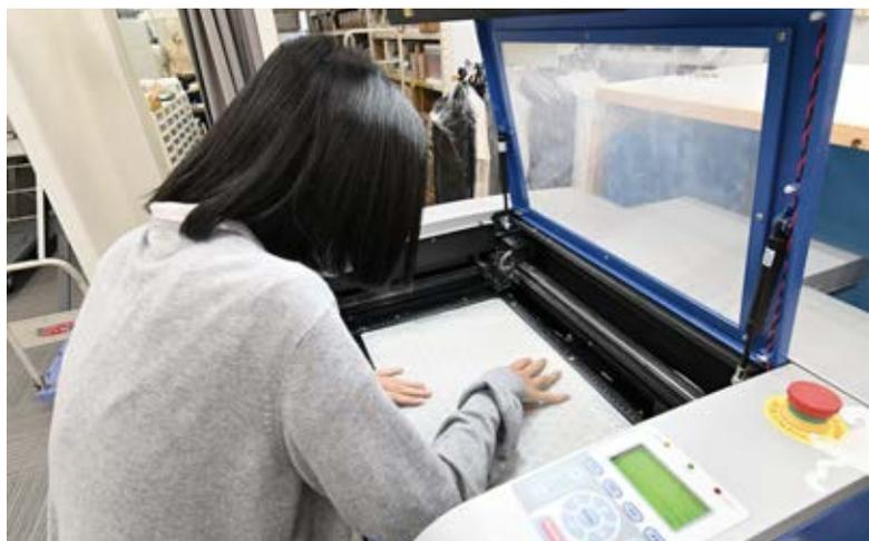
ステンシルシートの素材を曲がりなく、レーザー加工機にセットする
