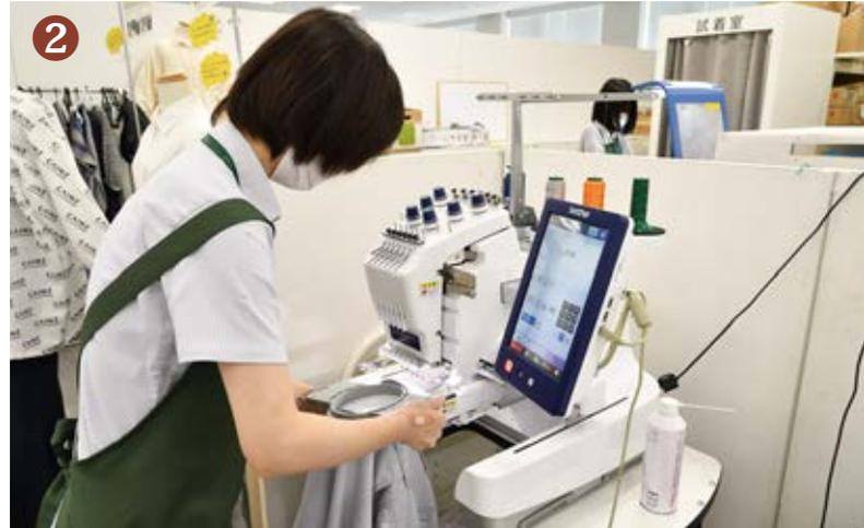
2 刺繍機に枠をセットする。位置のズレが仕上がりに影響するため重要な工程だ
