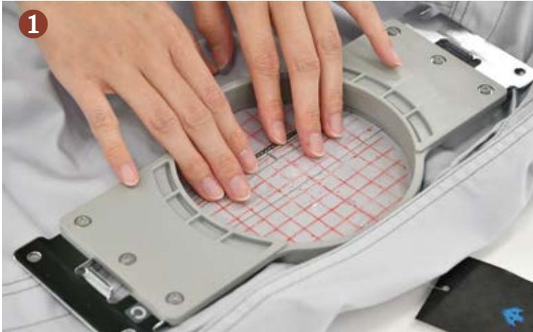
1 刺繍用の枠に作業着をはめ込む。ゆがみをなくすため、格子状の定規で確認する
