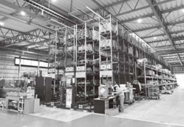
工場で使用する部材などが納められた自動倉庫
