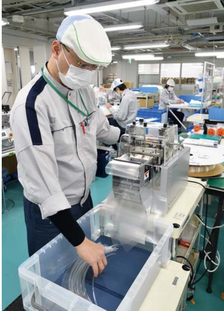
自動切断機を使用したチューブの切断作業を行う沖さん
