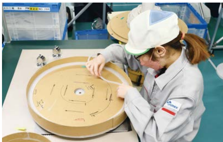
柔らかく伸びやすいシリコンチューブの検尺には、円筒状の治具を使用する
