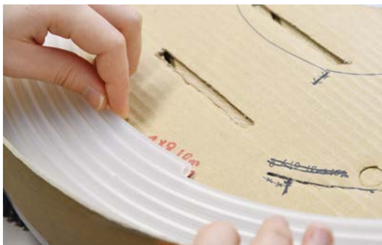
内周に沿ってチューブを巻くことでチューブが伸びず、正確に長さを測れる
