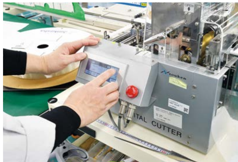
注文書に従って、自動切断機にチューブの長さや個数を入力する
