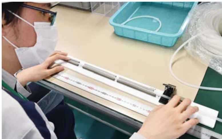
チューブの長さを測る検尺では、素材や長さに合わせて治具を使い分ける
