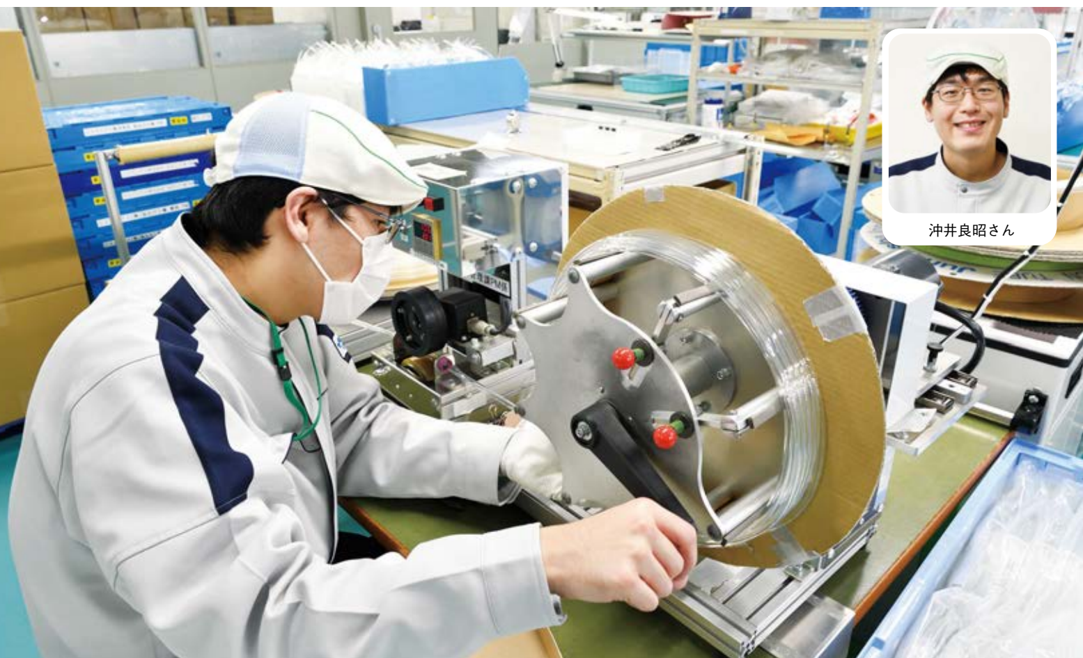
巻き取り式の治具を使用したウレタンチューブの検尺を行う沖井さん
