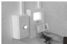
出勤カードリーダー。音だけではなく光により、カードが読み取れているかを確認できる
