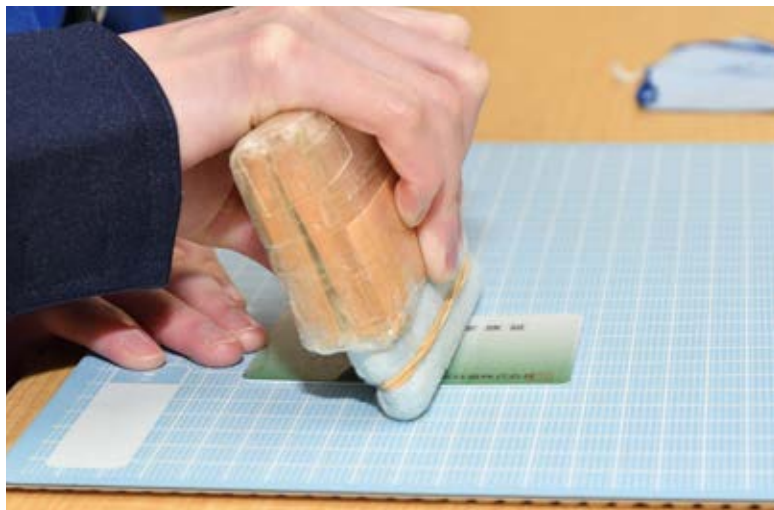
傷がついたりホコリが入ったりしないように注意が必要。 カードにフィルムを貼りつける道具もスタッフが工夫を凝らし自作している
