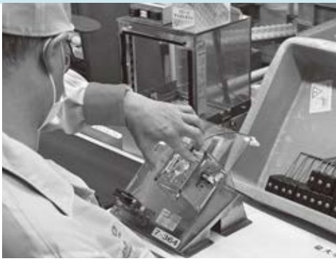
治具を活用した片手での組み立て作業
