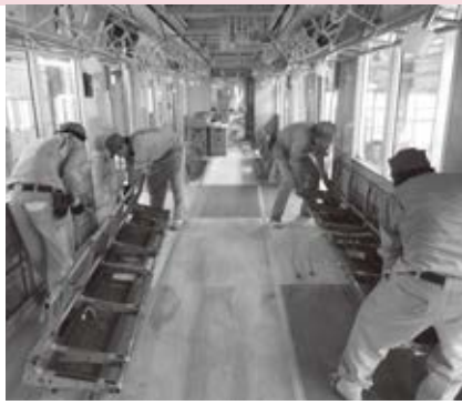
堀江車輛電装は、鉄道車両の整備や改造を手がける（写真提供：堀江車輛電装株式会社）
