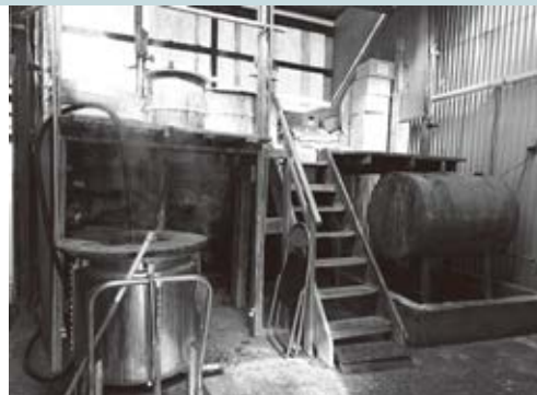
工場に据えつけられた「釜」を使い、「釜炊き職人」である障害のある社員が生油から石鹸を炊き上げる
