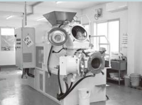
化粧石鹸などの製造に使用される「機械練り」の装置。障害のある社員が、操作やメンテナンスを担当している
