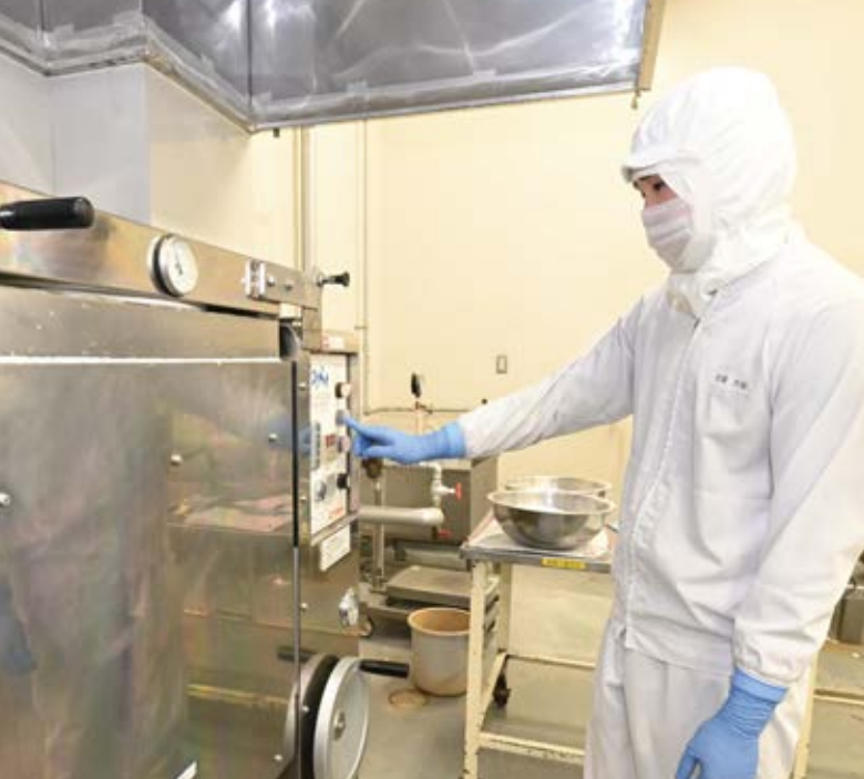
原料を投入した蒸練機を作動させ「もち」をつくる
