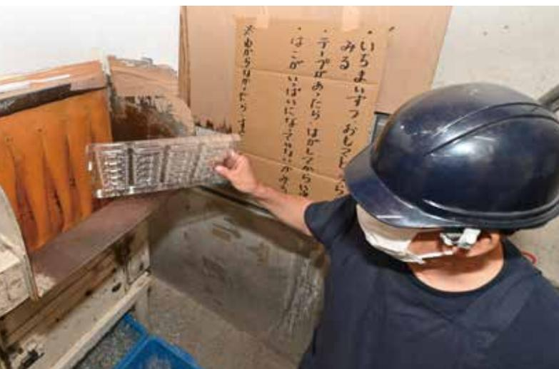
プラスチックのリサイクル作業では、プラスチック製のケースやトレイを素材ごとに分け、破砕機にかけてリサイクルに適した状態にする
