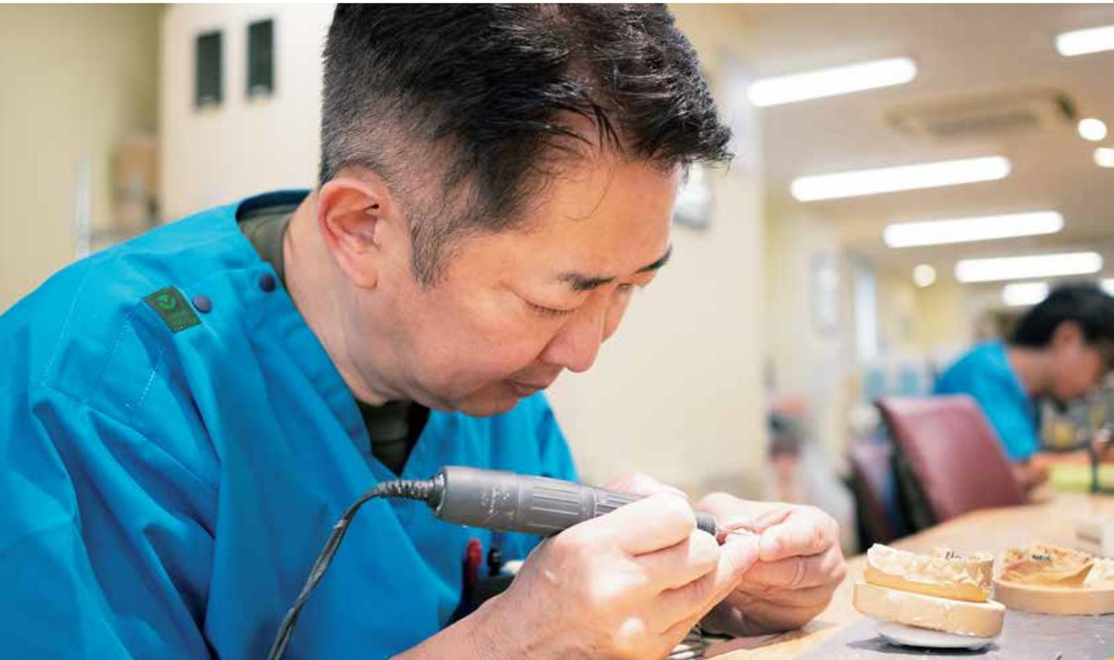
回転切削器具で微調整を行う。より自然な仕上がりの歯科技工物を目指す
