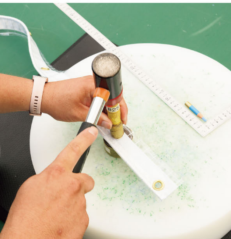
ハトメ加工は、シートの材質や厚さなどに合わせて、ハトメの大きさや取り付け位置が異なる。しっかりと確認したうえで作業を進めていく
