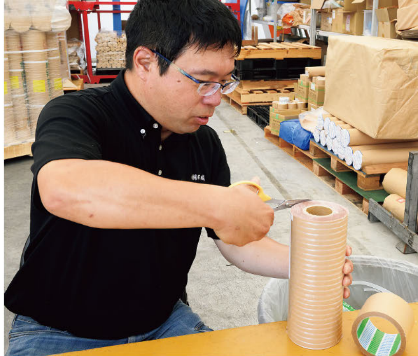
防湿シートの出荷準備をする武智さん。 切断したロールのバリを取り、梱包する
