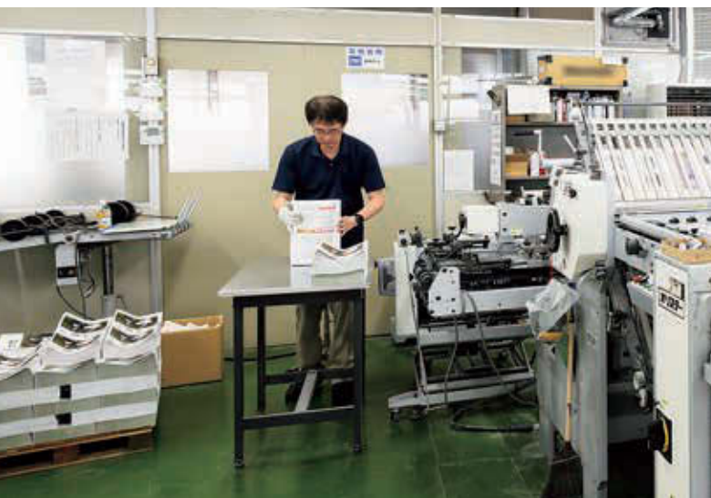
折り機では、大判の印刷物が折り込まれ、冊子状へと加工される
