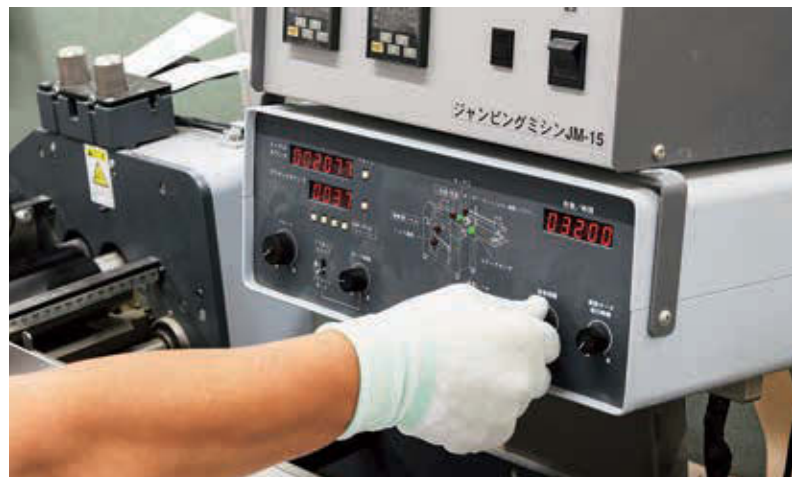
ミシン目が正しい位置になるように微調整を行う
