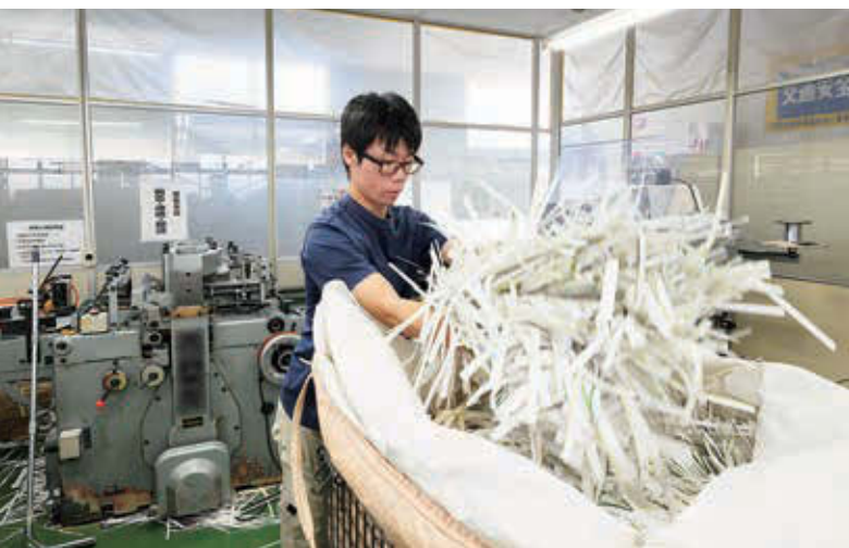
中綴じ製本機で断裁された切れ端をまとめ、フレキシブルコンテナバッグへと詰める
