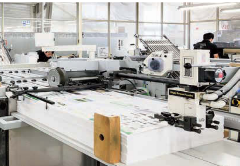
折り機では、大判の印刷物が折り込まれ、冊子状へと加工される
