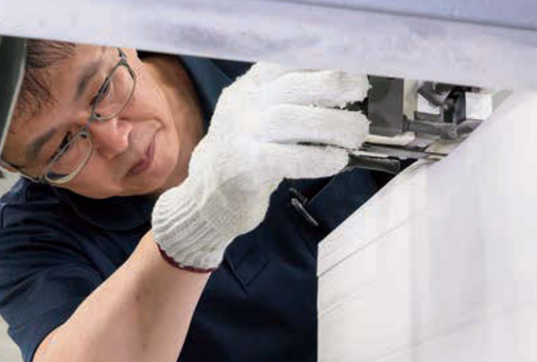
印刷物が一枚ずつ折り機に送り込まれるように調整を加える
