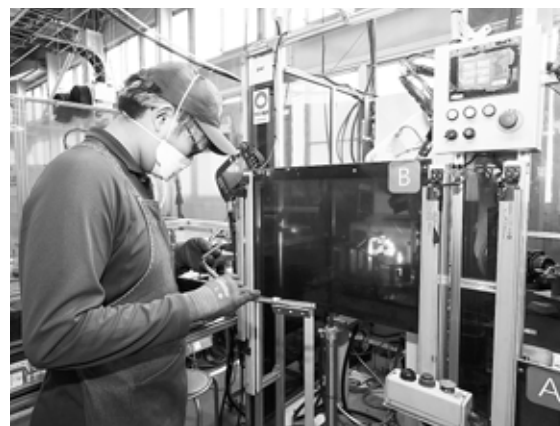
溶接を終えたパイプを確認する縣さん。 装置ではアーム型ロボットが溶接を行っている
