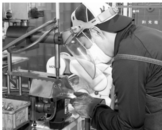
スポット溶接機を使い、仮づけされた部品を溶接する山田さん
