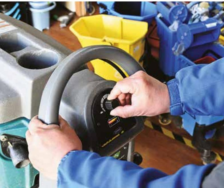
スピードを出しすぎると旋回がむずかしくなるため、スピード調整が大切だという
