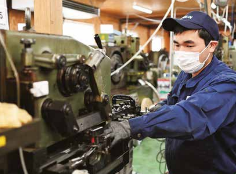
フォーミングマシンの送り込み装置に材料の板材をセットする
