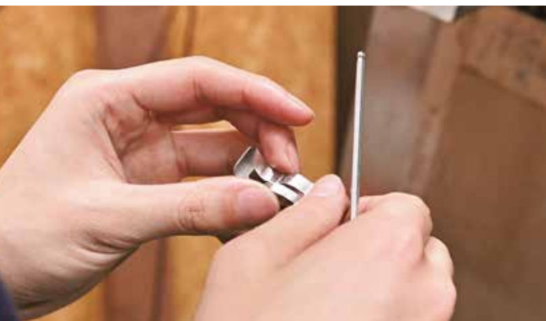
製造したバネ部品を指で触り、不要な突起（バリ）の有無を確認する
