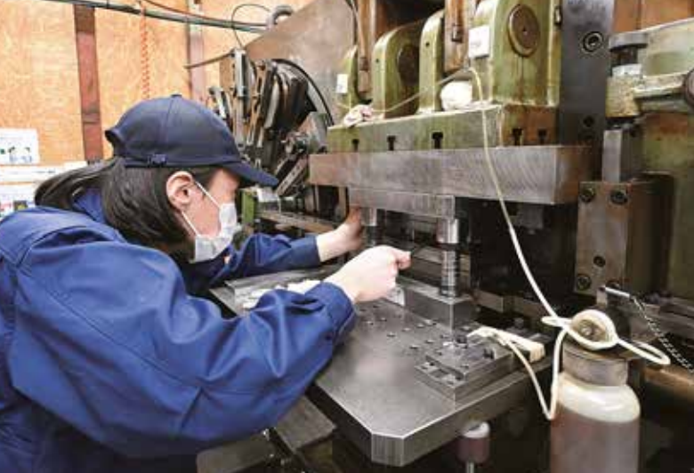
組み立てた金型をフォーミングマシンに取りつける
