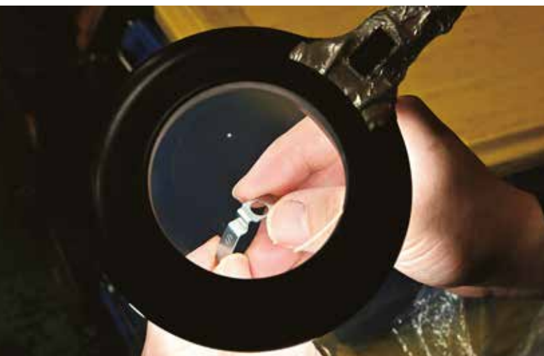
拡大鏡でバネ部品をすみずみまで観察し、傷の有無を確認する
