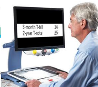
視覚障害向け機器 ＜据置型拡大読書器＞
