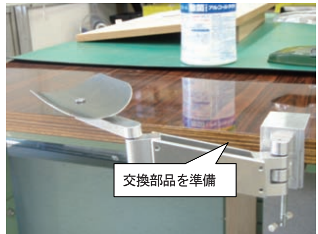
図2-13 機械加工科の協力を得て作成した自助具
