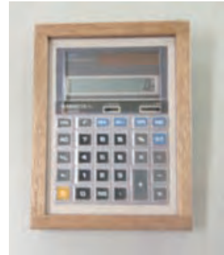
〔図① 木とアクリル板で製作した電卓カバー〕
