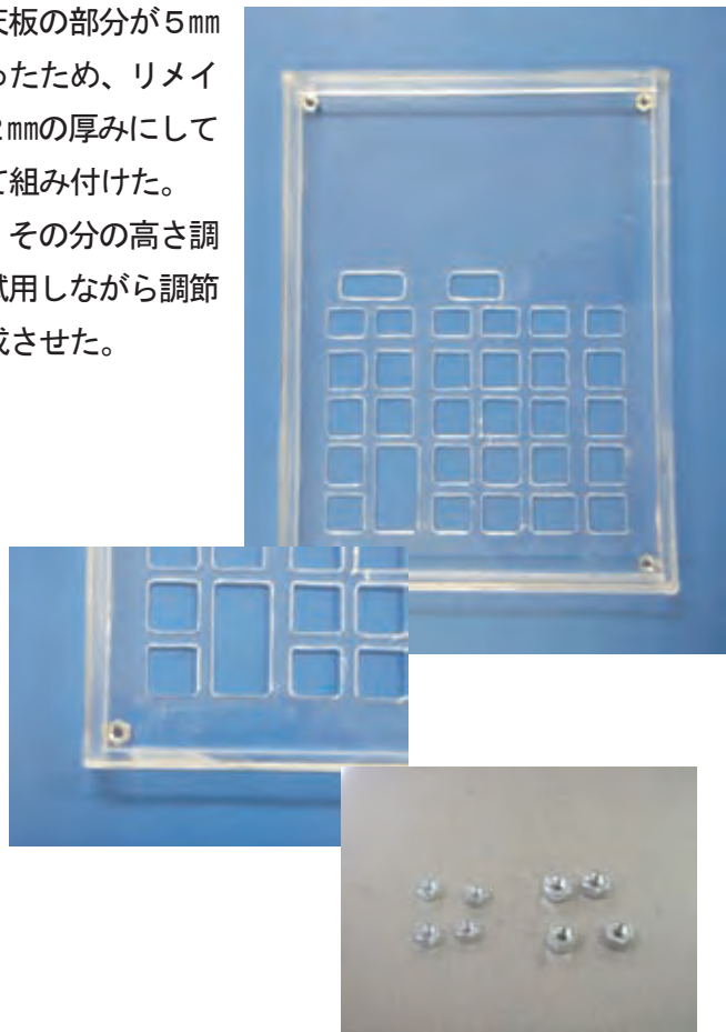
〔図② アクリル板のみで製作した電卓カバー〕
