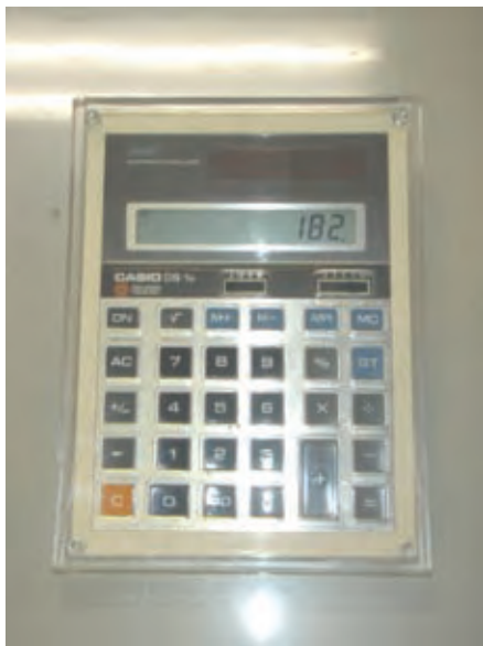
〔図② アクリル板のみで製作した電卓カバー〕
