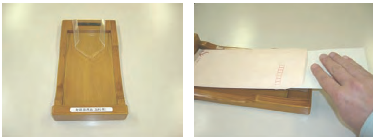
図2-21 封筒詰め自助具と使用例
