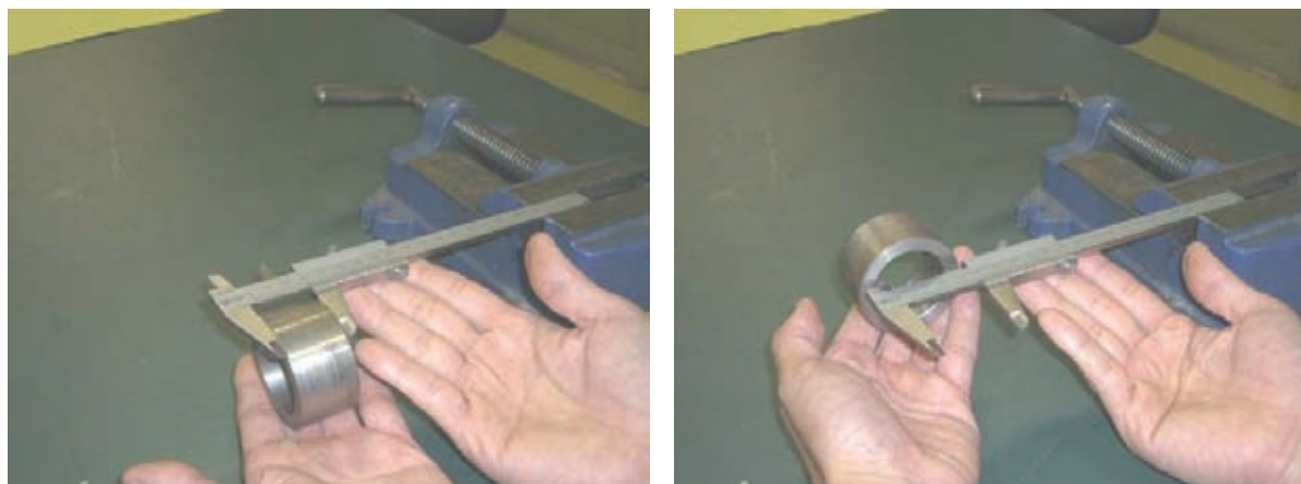
図2-18 卓上バイスを利用したノギスによる測定（左：ジョウ、右：クチバシ）
