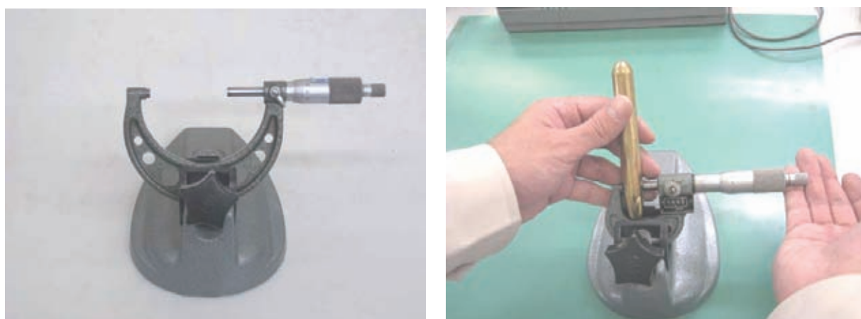
図2-19 マイクロメータスタンドを利用した測定
