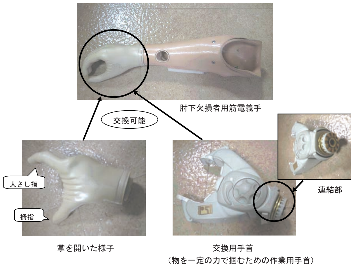
図 2-1 筋電義手サンプルその 1 (写真提供：国立障害者リハビリテーションセンター)
