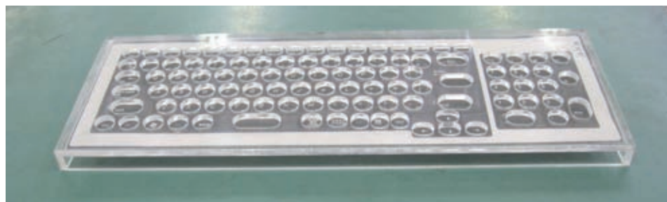
図2-26 マシニングセンタで自作したキーボードカバー
