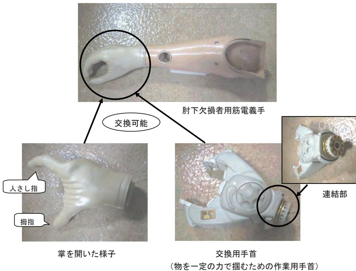
図 2-1 筋電義手サンプルその 1 (写真提供：国立障害者リハビリテーションセンター)
