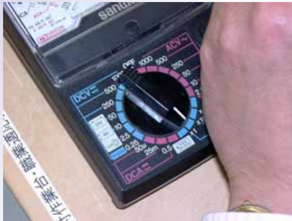
図 1 0 テスターのレンジを合わせる
