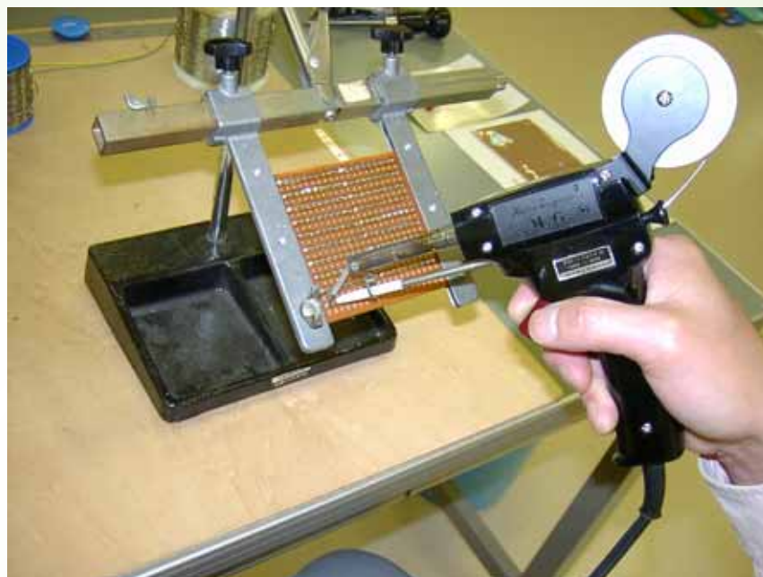
図5 自動はんだごてを使用しての作業の方法
