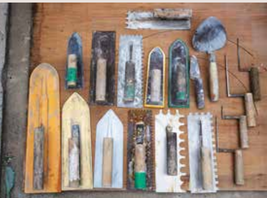
タイル張りはコテを使いこなす技能でもある。下地のモルタルを平滑にしたり、目地を整えたりするのに、さまざまなコテを使い分ける
