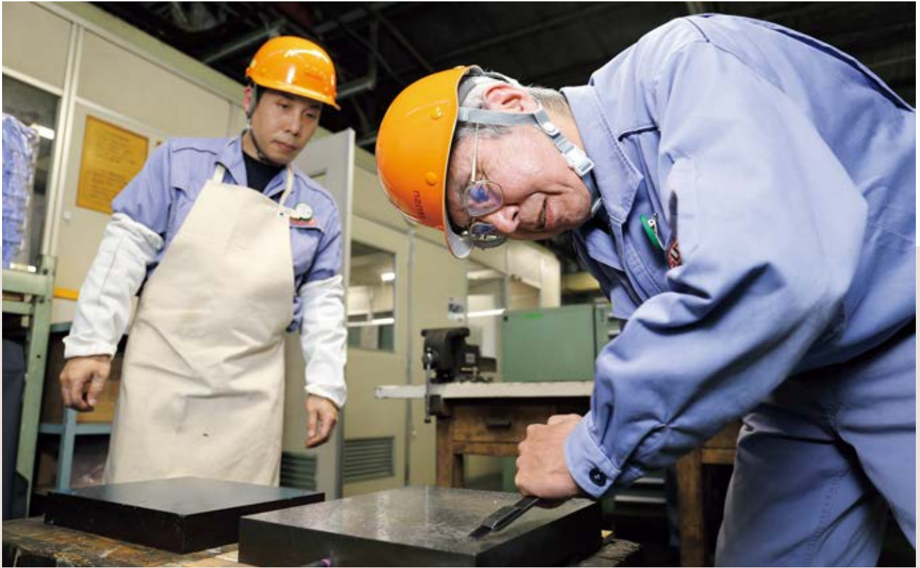
技能検定の練習用の定盤に「きさげ」をかける千葉さん（右）。その作業の様子を、千葉さんの後継者にあたる中野一登 なかのかずと さんが見つめる
