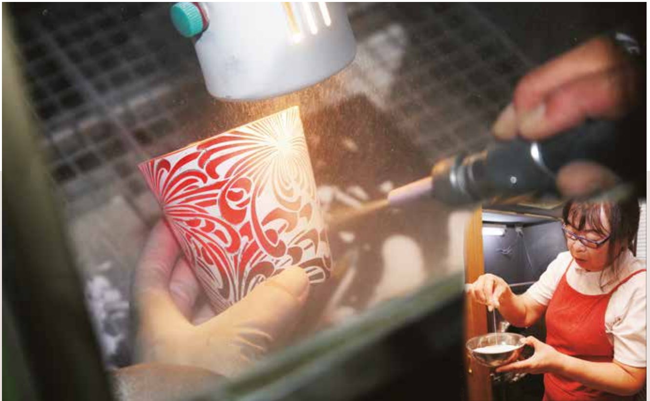
被せガラスのマスキングを剥がした部分に、砂状の研磨剤を空気圧で吹きつけて削る。浅く削ると色が濃く、深く削ると色が薄くなる。
